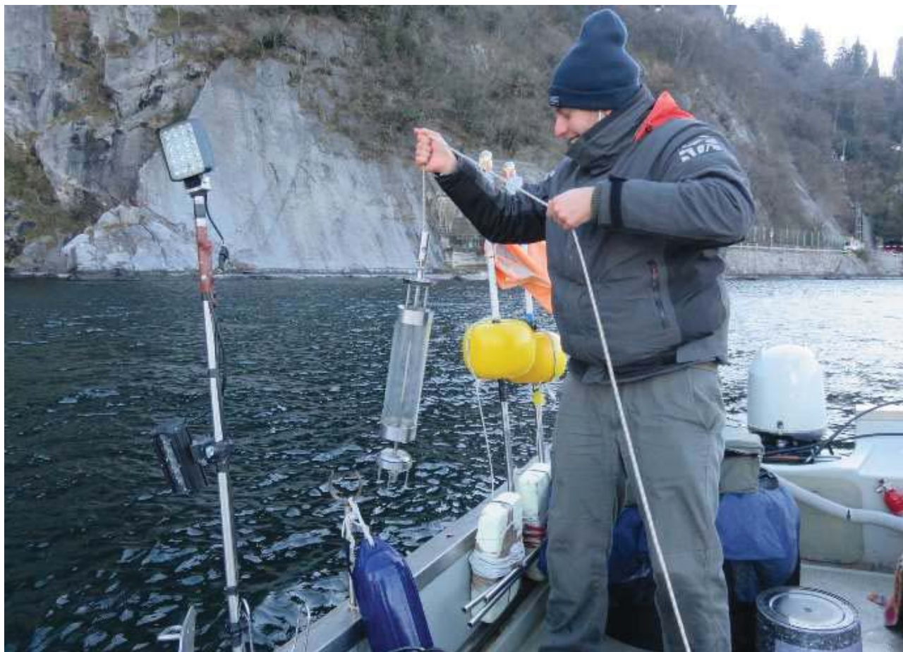
Figura 5-1. Campionamento dell'acqua con bottiglia di profondità
