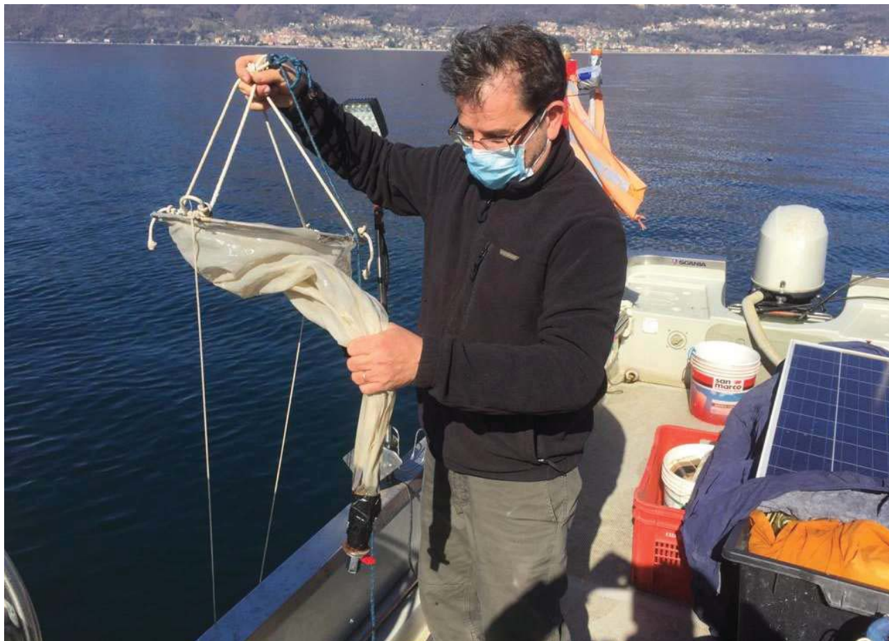
Figura 5-2. Campionamento dello zooplancton
